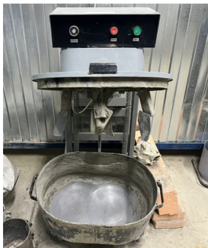
Рис. 2. Смесители принудительного действия: а – ЛБ-АБ-10; б – СБР132А
