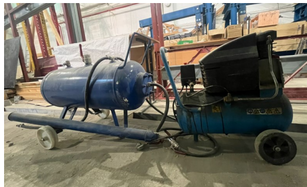
Рис. 1. Лабораторный пеногенератор с пенопатроном и компрессором
