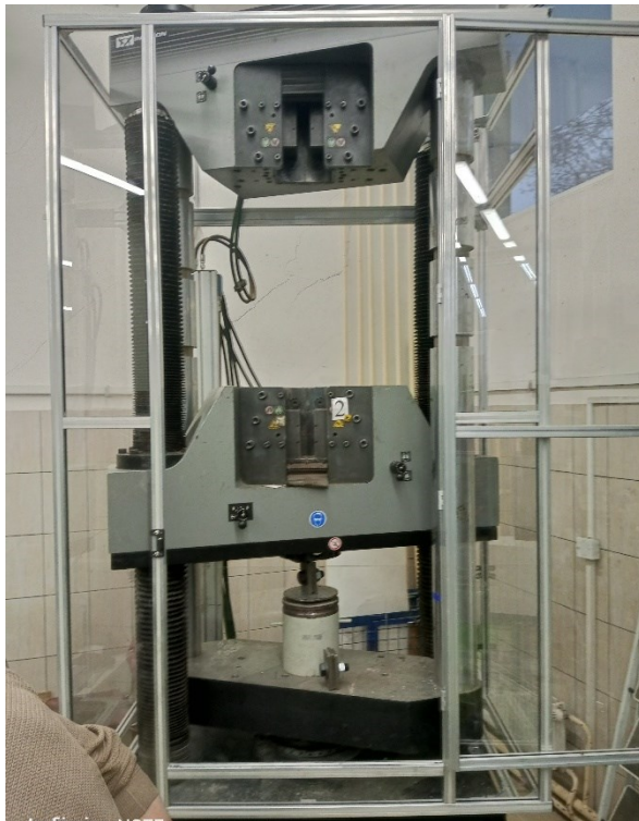
Рис. 2. Испытание образцов на сжатие на разрывной машине Instron 1000HDX
