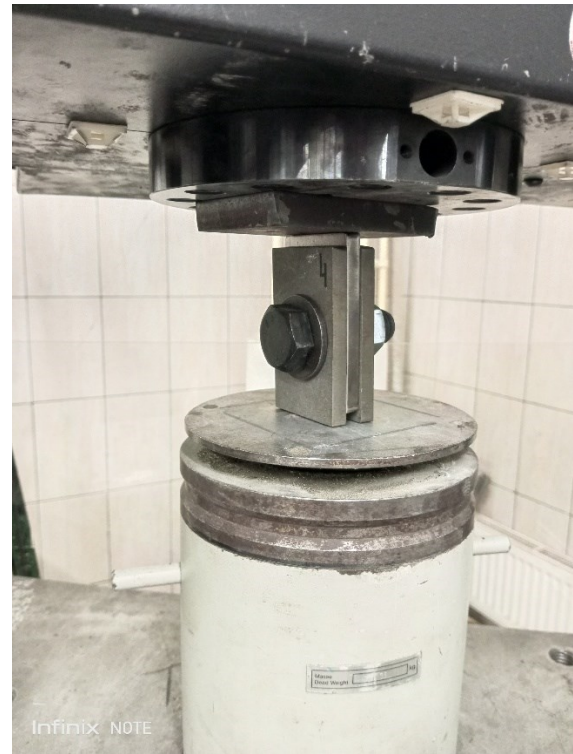
Рис. 2. Испытание образцов на сжатие на разрывной машине Instron 1000HDX
